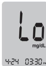
Figura 50. O resultado de teste é inferior a 10 mg/dL.
