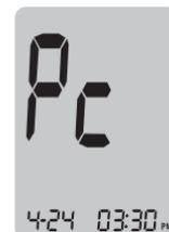
Figura 51. O aparelho medidor de glicose está conectado a um computador.
