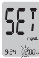
Figura 18. Programar a hora no aparelho medidor.
