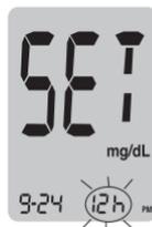
Figura 17. Programar o formato da hora no aparelho medidor.
