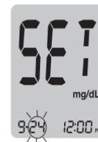
Figura 16. Acertar o dia no aparelho medidor.
