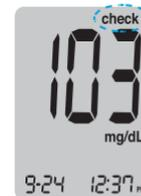
Figura 29. Tela do medidor com a função check ativada.
