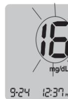
Figura 20. Ajustar o ano no aparelho medidor de glicose.
